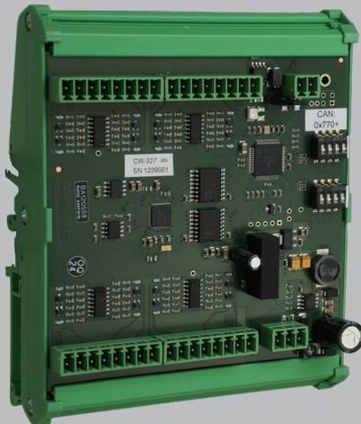
Mit dem CW-327 erweitert sich die CW-300er-Serie für Prüfstandstechnik um ein Modul zum Messen von 16 analogen Spannungen. Diese Spannungen können bei einer Auflösung von 16 Bit von 0 bis max. 60 VDC pro Kanal gemessen werden. Geräteeinstellungen, wie Baudrate des CAN-Busses, Ausgaberate, Spannungsbereiche und Sendemodi können komfortabel über CAN-Botschaften konfiguriert werden. Alle 16 Eingänge werden synchron abgetastet und auf dem CAN-Bus ausgegeben.
