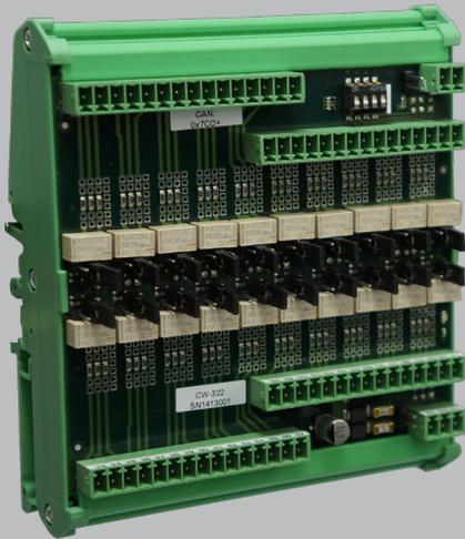
Mit CW-322 erweitert sich die CW-300er-Serie für Prüfstandstechnik um ein Modul zur Ansteuerung von bis zu 20 Signalrelais über CAN-Bus. Dabei wird nicht nur die gezielte Auswahl eines einzelnen Relais unterstützt, sondern auch die synchrone Ansteuerung mehrerer Relaiskanäle.
