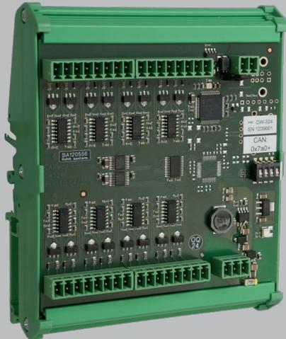
Mit dem CW-324 erweitert sich die CW-300er-Serie für Prüfstandstechnik um ein Modul mit 16 Stromsenken. Jede Stromsenke kann bei einer hohen Auflösung von 12 Bit frei zwischen 0 und 20 mA eingestellt werden. Die Stromstärke kann darüber hinaus bis zu 100.000 Mal pro Sekunde neu definiert und an allen 16 Kanälen synchron geschaltet werden.
