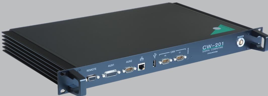
Das CW-201 dient zur mehrkanaligen Echtzeitverarbeitung von Audiosignalen und basiert auf äusserst leistungsfähigen Signalprozessoren. Primär als Entwicklungsplattform für Sound-Design in Kraftfahrzeugen konzipiert, findet das CW-201 ebenfalls Anwendung in der Vibroakustik. Mit bis zu 18 analogen Eingängen und ebenso 18 analogen Ausgängen können Mikrofone, Schwingungssensorik und Audio-Leistungsverstärker direkt am Gerät angeschlossen werden.
